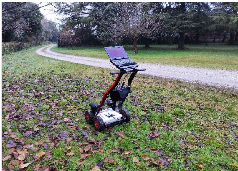
Georadar utilizzato per verifica preliminare presenza sottoservizi
